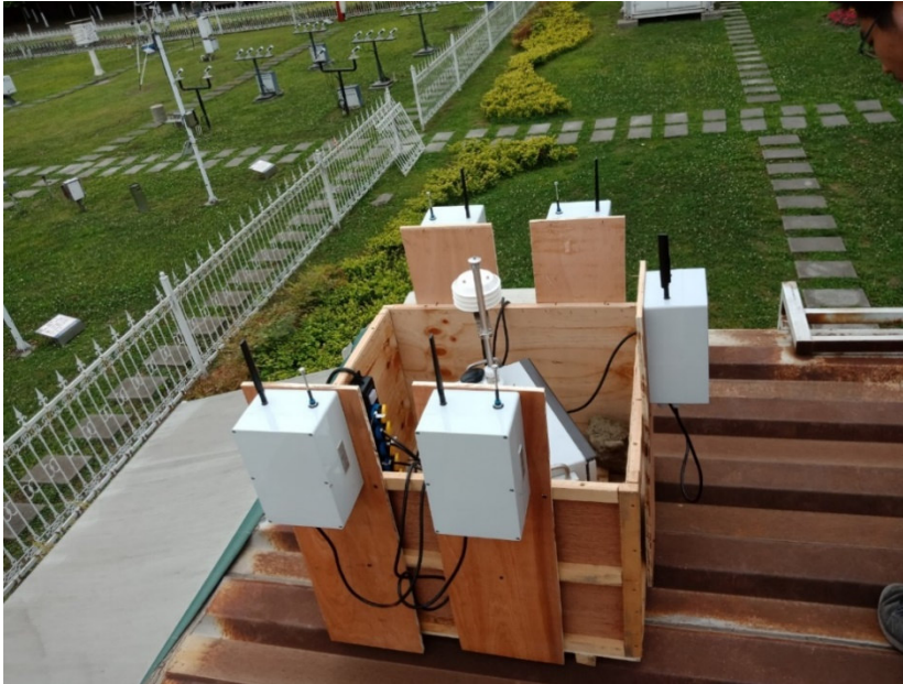
Abbildung 5: Ein vergleichbarer Messaufbau wie am Messcontainer in Augsburg wurde für die Vergleichsmessung in Chengdu errichtet (Foto: GRIMM)
